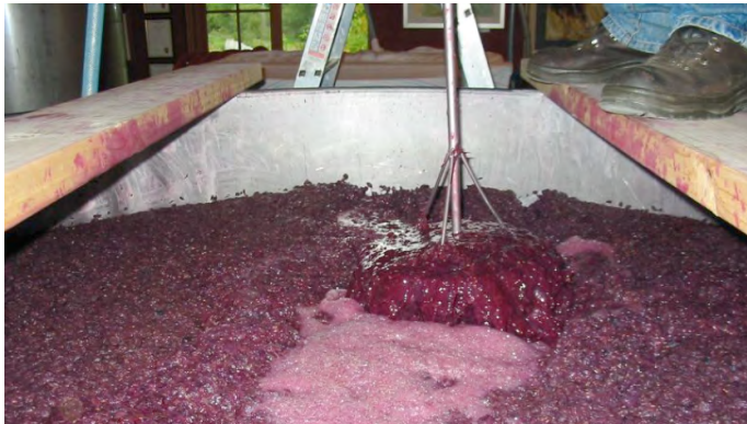
Imagen 5: Labores en aberturas superiores de depósitos: rotura del sombrero
