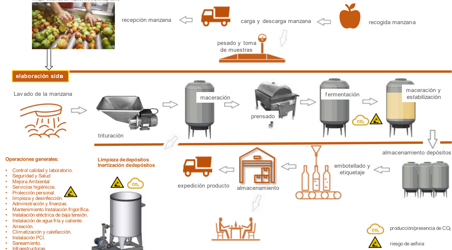
Ilustración 14. Proceso de Elaboración de sidra y etapas con exposición a CO 2 y riesgo de asfixia. Elaboración propia.
