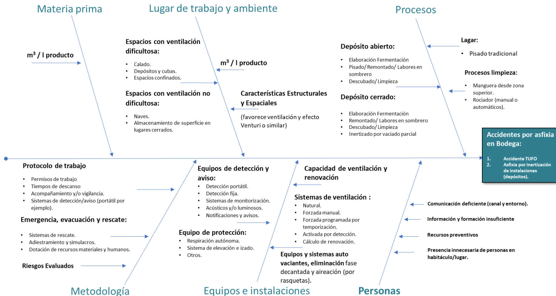
Ilustración 20.- Análisis Ishikawa: Análisis de Factores de Riesgos potenciales para accidentes por TUFO e inertización de depósitos. Ámbito Euskadi. Elaboración propia.
