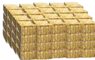
Pilaketa bertikala, ondo orekatua, baina trabatu gabea. Arrisku txikia, piloak makineria egokiz kentzea bermatzen bada eta egonkortasuna aldizka kontrolatzea ezartzen bada.
