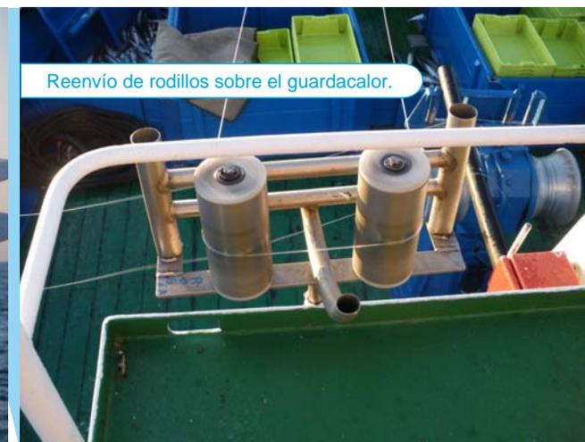
Reenvío de rodillos sobre el guardacalor.
