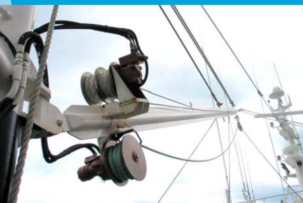
Puntal de proa y motores hidráulicos de amantes (izado y arriado) y ostas (movimiento trasversal).
