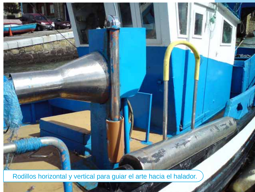
Halador monobloque de cabirón cónico sobre cubierta.
