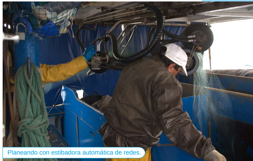
Preparando la estibadora automática de redes.
