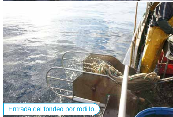
Fin halado de redes, inicio halado del cabo de fondeo.
