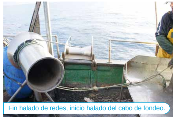
Izado del fondeo de finalización.
