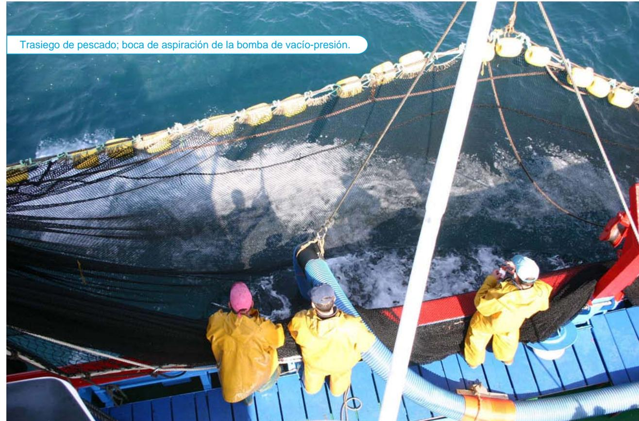
Trasiego de pescado; boca de aspiración de la bomba de vacío-presión.
