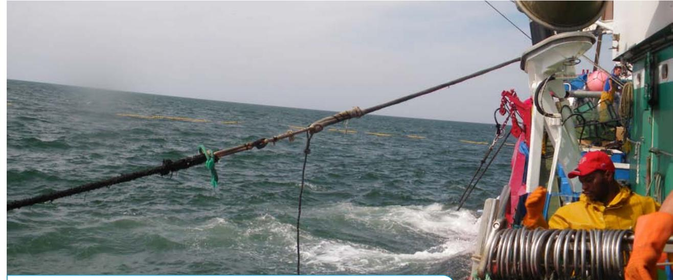
Virado del arte; inicio del virado del calón de popa con el halador de rodillos TRIPLEX.
