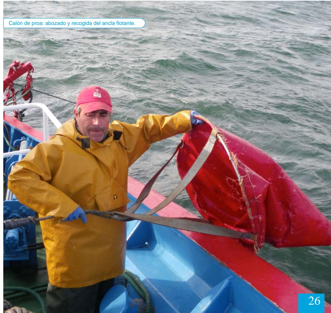
Calón de proa: abozado y recogida del ancla flotante.
