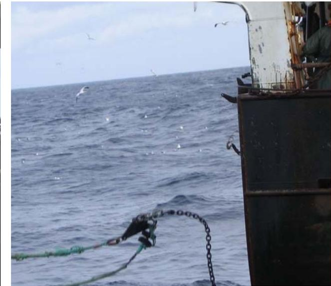
Una vez que el cabo de leva llega al buque “B”, se pasa por el exterior del pórtico de popa hasta ser enganchado en el ramal de cadena del calón, que a su vez está trincado en el perro o gancho disparador, mediante una cadena. Así, en “B” queda lista la maniobra para que el calón sea zafado a la orden que dé el buque “A”.
