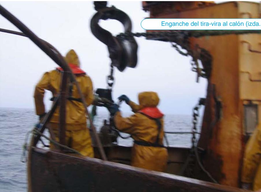
Enganche del tira-vira al calón (izda.) y virado del calón hasta cubierta.
