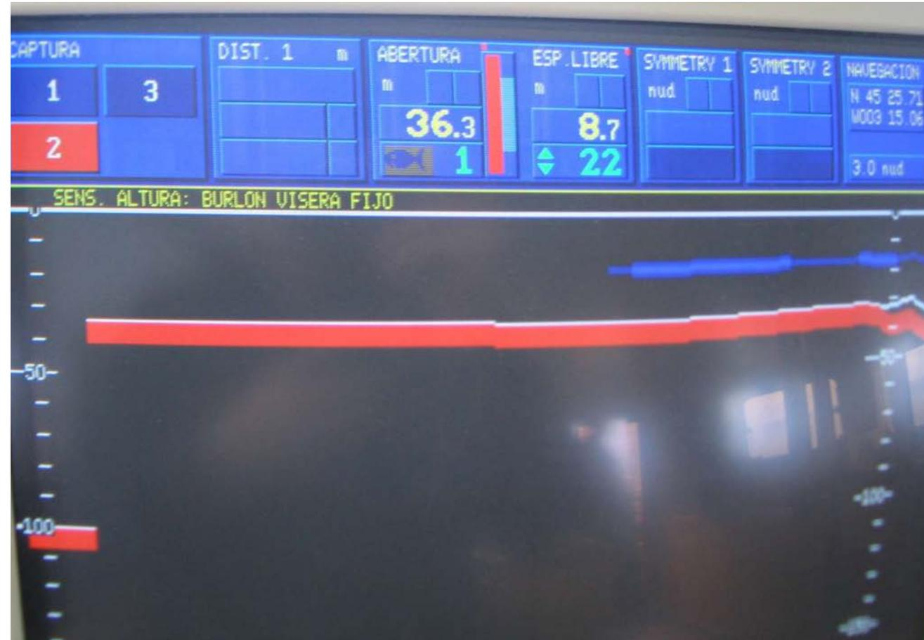
Monitorización del arte. Sensor de captura activo –en rojo– y virado del arte; se observa la separación del burlón con el fondo: 8,7 metros.
