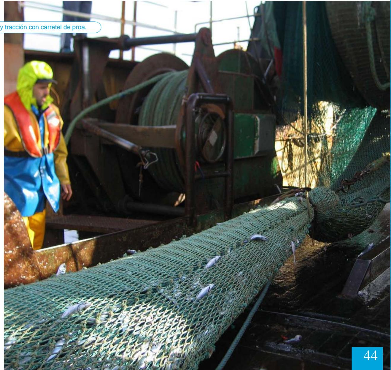
El lanteón se iza ligeramente sobre cubierta y se pasa una eslinga de cadena o poliéster alrededor como elemento intermedio que permite enganchar, a su vez, otro gancho de lanteón para izar el saco a cubierta.
