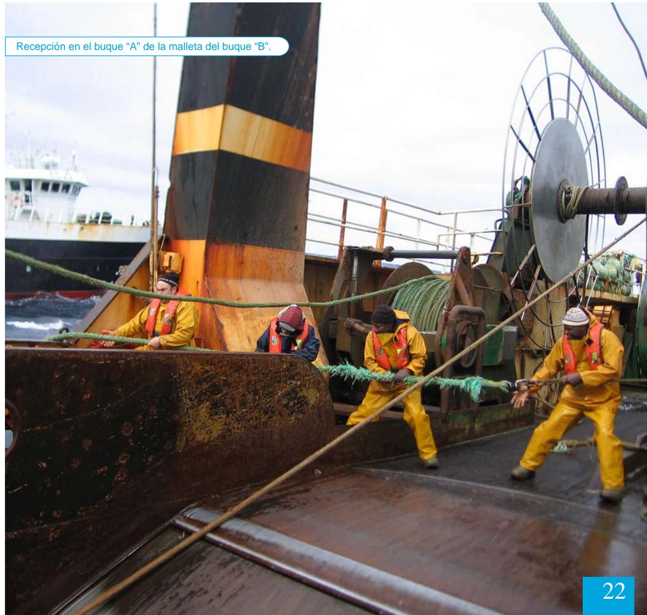
Cuando llega a bordo, se zafa, se pasa por fuera –aleta de babor– del pórtico de popa, y se engancha en el ramal de cadena que pende del calón de babor mediante una “G”.
