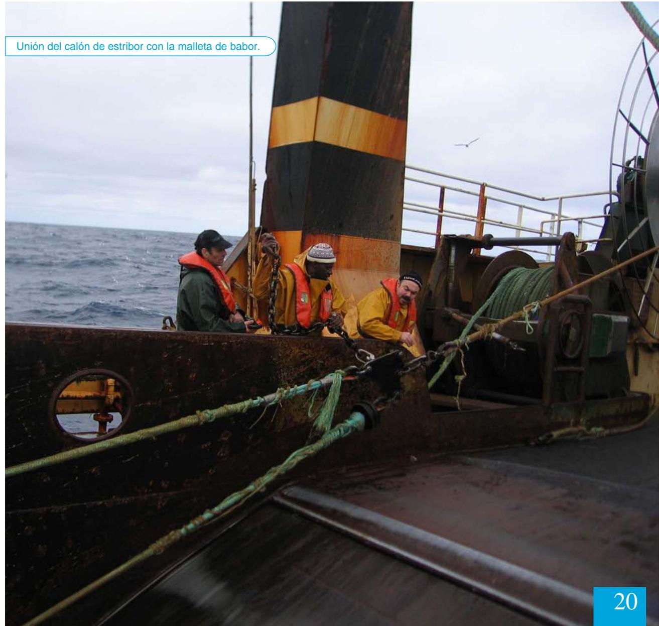
Una vez que el calón de babor está dispuesto en el gancho disparador, se lleva la malleta al calón de estribor y se une al ramal de cadena del calón mediante un gancho tipo “G”.
