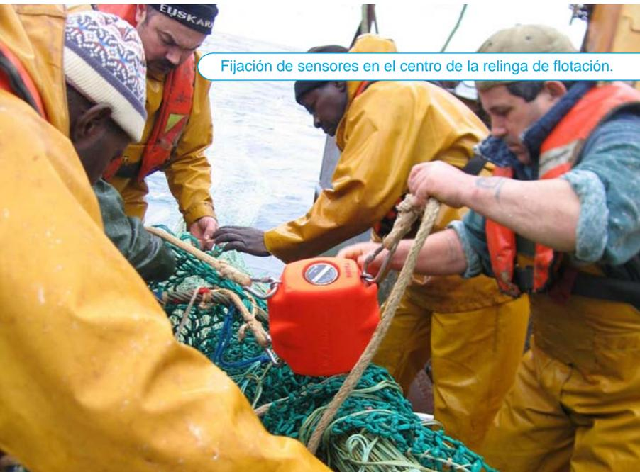
Fijación de sensores en el centro de la relinga de flotación.
