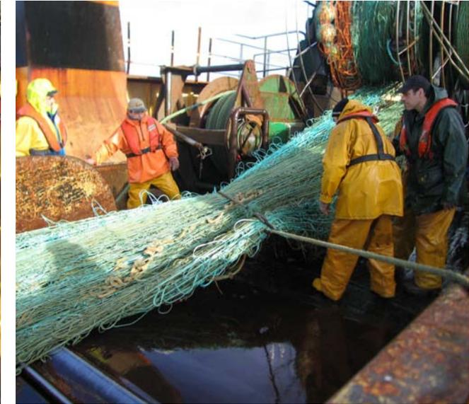
Una vez que el sensor ha sido zafado de sus de sus anclajes, se vira el cabo dispuesto de banda a banda mediante un cabrestante o molinete para recoger las bocas del arte. Cuando la boca del corcho y la del plomo se juntan, se pasa un estrobo para que entren uniformes en el carretel.
