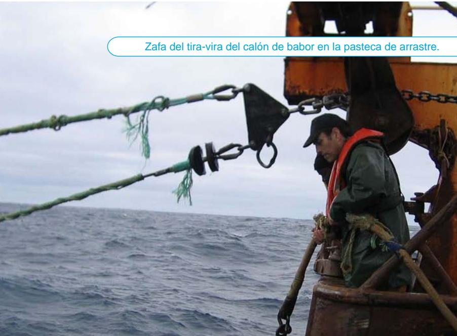
Paso de la cadena por la anilla del calón de babor para su trincado en el gancho disparador.
