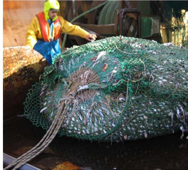
Una vez que el copo está en cubierta y en las inmediaciones del pantano, se libera la cuña del cierre del saco tipo “Boss” virando del molinete o cabrestante.
