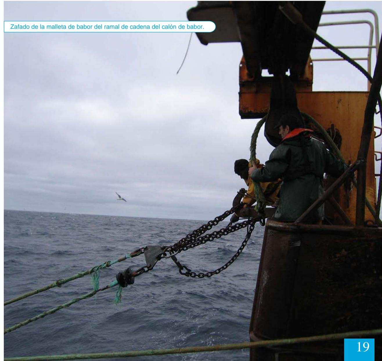
Se arría de la malleta hasta que el calón de babor quede firme por el gancho disparador y se vuelve a llevar la malleta hasta el calón de estribor.
