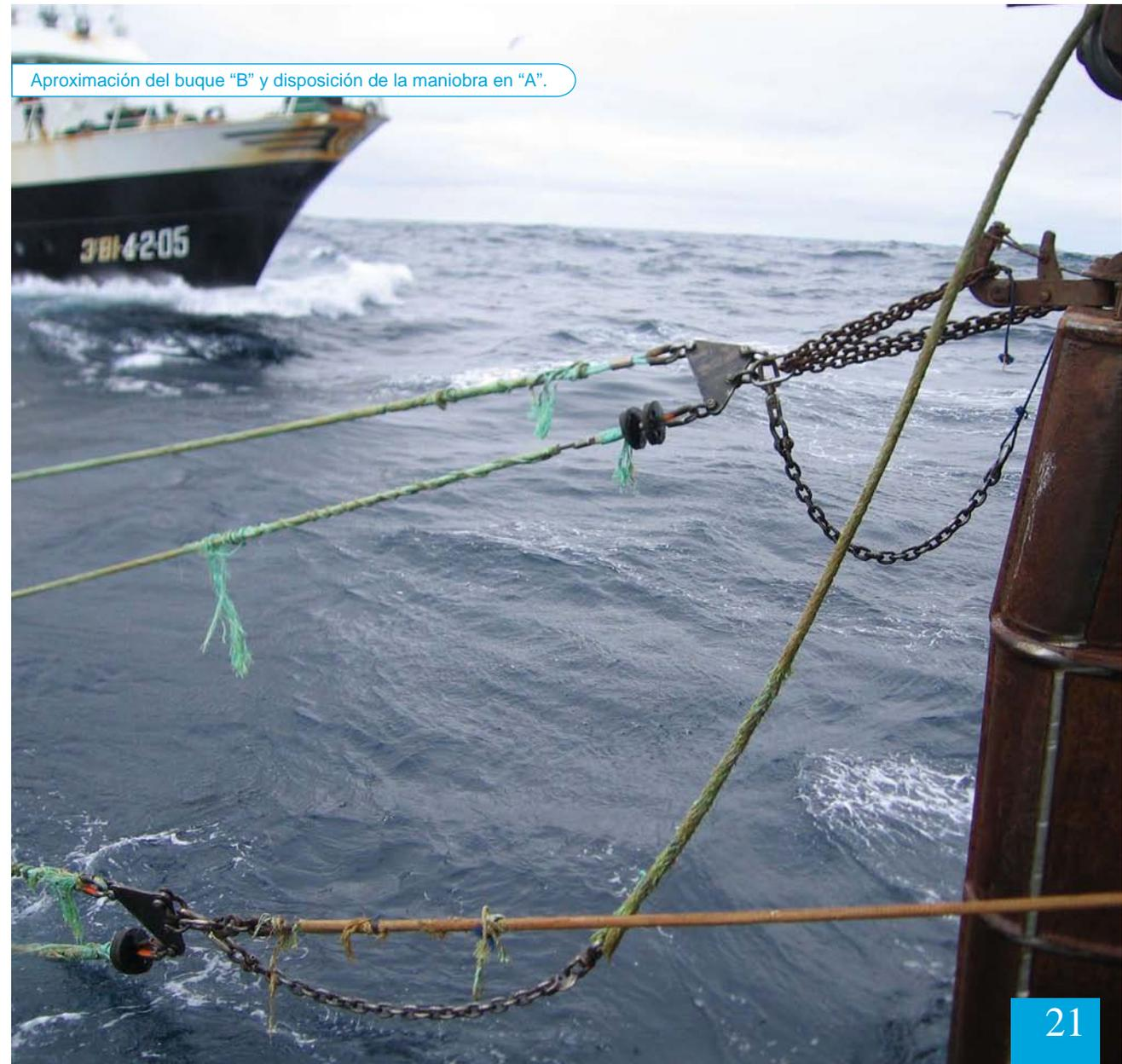
En estas condiciones, con el calón de babor sujeto en el gancho disparador, el calón de estribor sujeto por el tira-vira y la malleta engrilletada en el ramal de cadena del calón, se lanza una piña al buque “B” mediante la que se trae un cabo –cabo de leva– al que va enganchada la malleta del buque “B”.
